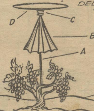
LLEGADA LA TORMENTA, ASI QUE LAS PRIMERAS PIEDRAS REBOTAN SOBRE EL DISCO, ESTE OPRIME EL RESORTE, EL DISPOSITIVO SE PONE EN MOVIMIENTO Y EL PARAGUAS EMPIEZA A ABRIRSE.
